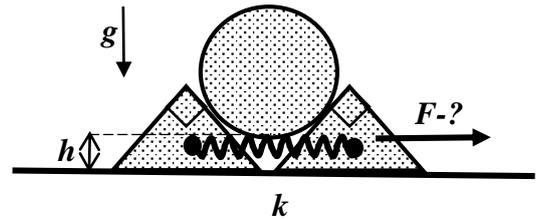
увеличивающуюся силу, в результате чего система пришла в движение, и цилиндр стал постепенно, без колебаний, опускаться. При какой минимальной силе он коснется поверхности в основании конструкции? Все тела имеют одинаковую массу. Трения нет.
