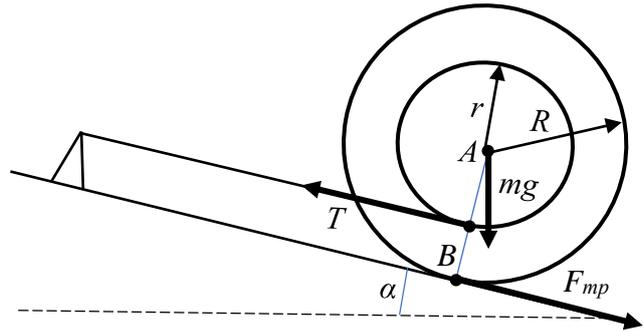
Рассмотрим баланс моментов сил относительно центра катушки  $A$  (см. рисунок):  $F_{mp}R = Tr$ . Баланс моментов сил относительно оси  $B$ :
