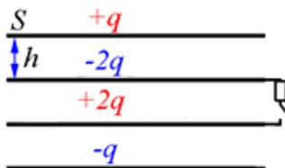
3. Четыре металлических пластины площади  $S = 0,01$  м<sup>2</sup> каждая расположены на одинаковом расстоянии  $h = 1$  мм друг от друга. На пластинах находятся заряды  $+q = 0,1$  мкКл,  $-2q$ ,  $+2q$ ,  $-q$ . Сколько тепла выделится, если соединить две средние пластины проводником? Ответ приведите с точностью до трех значащих цифр.
