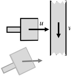
2. Движущаяся со скоростью  $v = 1$  м/с лента транспортера равномерно нагружена сыпучим материалом. В перемещаемый со скоростью  $u = 1,9$  м/с поперек ленты совок, можно собрать  $m = 1$  кг материала. Какая масса этого материала попадет в совек, если его двигать с той же скоростью поперек ленты, но держать под углом  $\alpha = 30^\circ$  к ленте? Объем совка не ограничивает количество материала. Ответ приведите с точностью до 3 значащих цифр.
