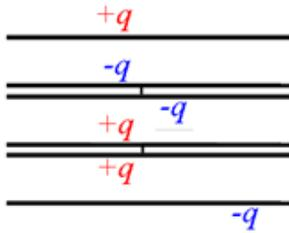
Можно представить конструкцию, как три последовательно соединенных одинаковых конденсатора. Емкость каждого конденсатора  $C = \frac{\epsilon_0 S}{h}$ , заряды у всех  $q$ . После соединения средних пластин (замыкания среднего конденсатора) его начальная энергия  $W_0 = \frac{q^2}{2C} = \frac{q^2 h}{2\epsilon_0 S} \approx 5,7 \cdot 10^{-5}$  Дж переходит в
